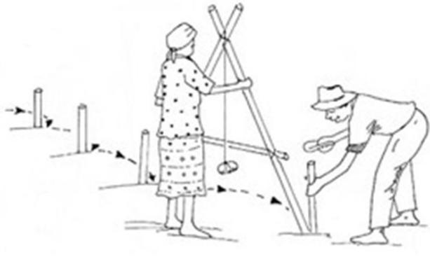
*Outils d'arpentage pour le placement correct des cordons de contour:
