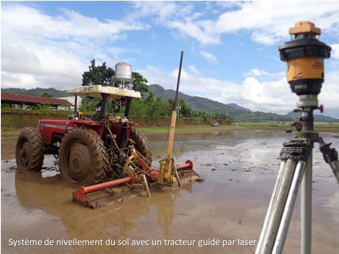
Systeme de nivellement du sol avec un tracteur guidé par laser
