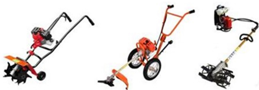
Désherbeurs mécanisés: Une mini-bineuse à dents verticales (à gauche), une coupeuse à lame rotative horizontale (au centre) et une sarcleuse à dos polyvalente (à droite)
