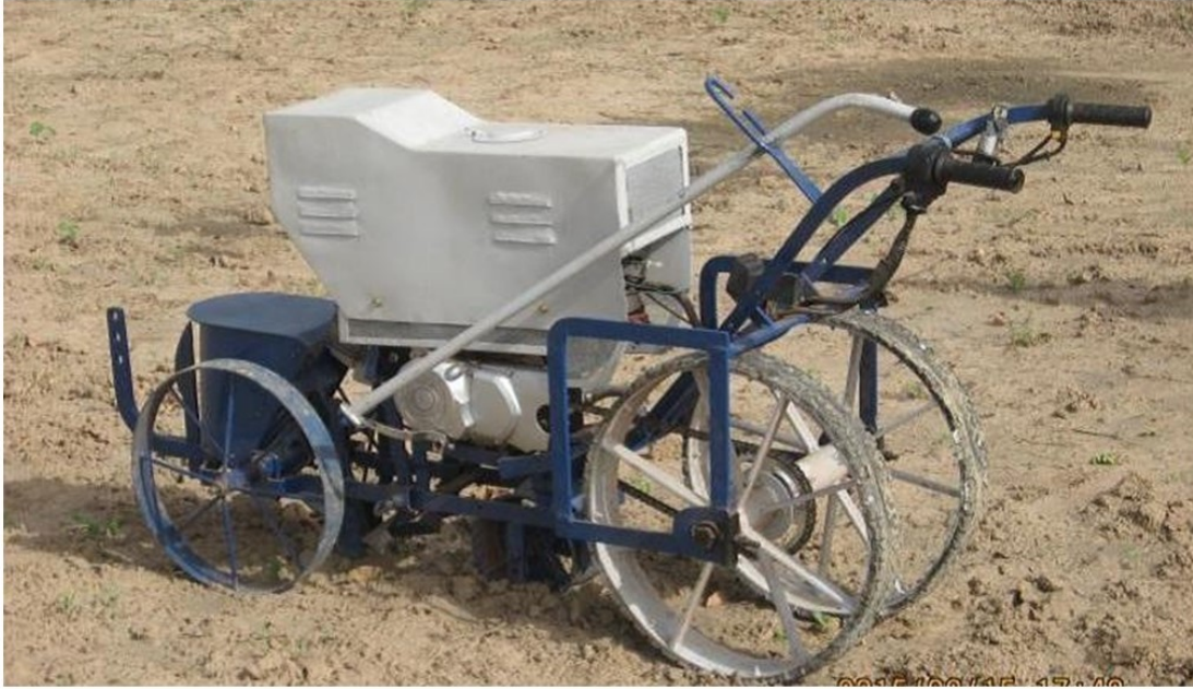
Semoir Sénégalais et épandeur d'engrais à microdose
