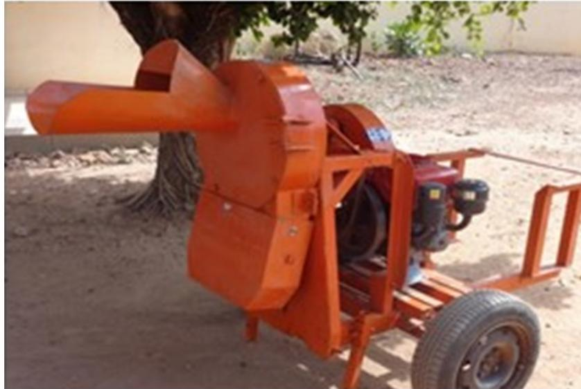
*Hachoir à fourrage avec moteur intégré*
