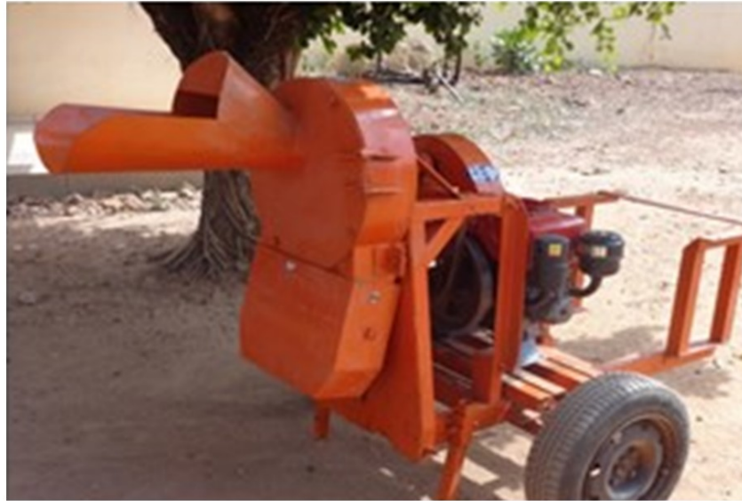
Hachoir à fourrage avec moteur intégré
