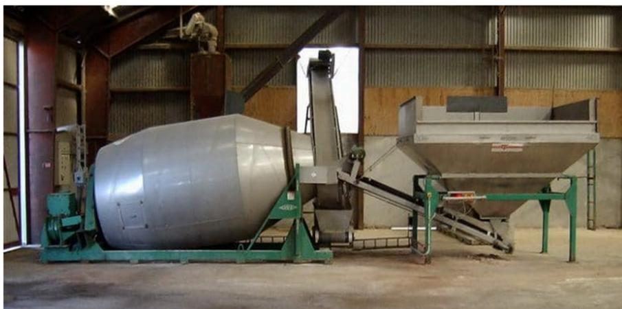
*Système rotatif utilisé dans le mélange des engrais*
