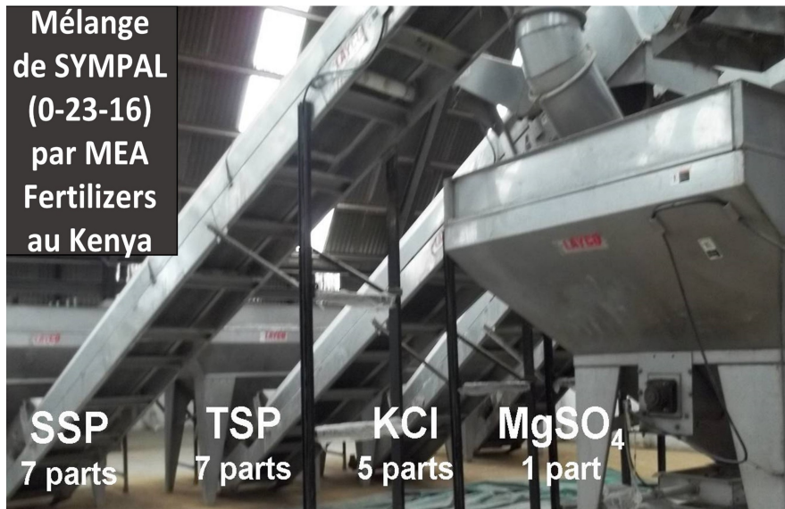
Un mélangeur multicanaux en fonctionnement chez 'MEA Fertilizers' utilisé pour produire du SYMPAL pour les légumineuses à grain au Kenya
